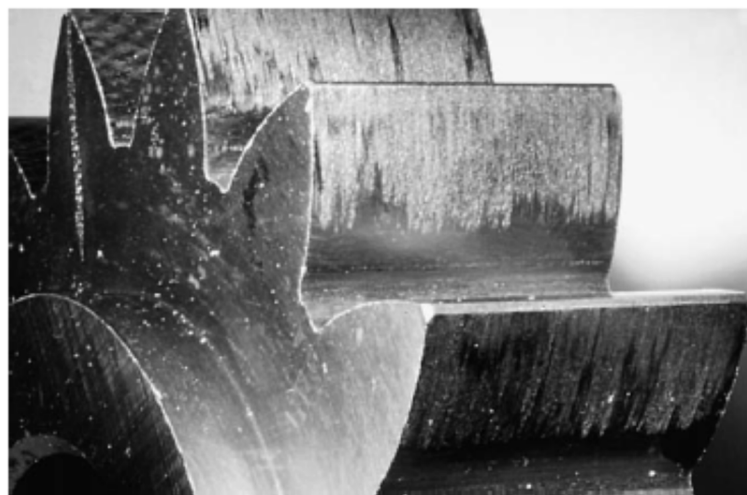
Figure III.4 : Défaut de grippage.
