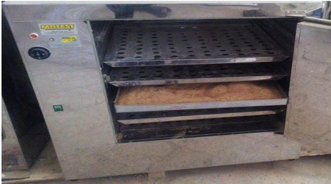
Figure II-5 : séchage du bois de palmier dattier dans les étuves.
