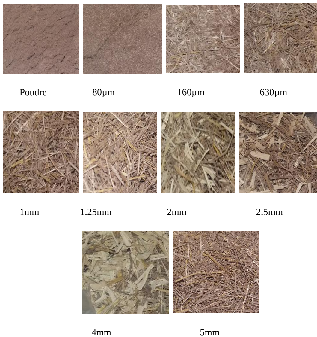
Figure II-9 : les différentes tailles obtenues après tamisage.
