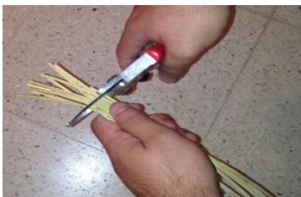
Figure II-3 : découpage des branches de Palmier dattier
