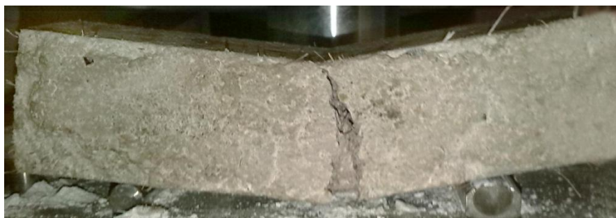
Figure II-14 : échantillon de CC/ FBPD après flexion
