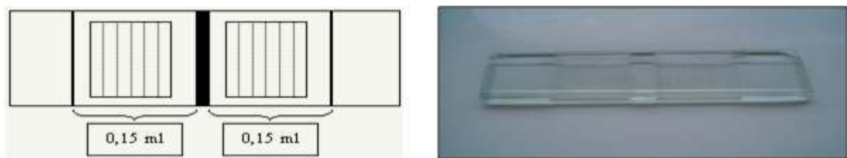
Figure12 : Schéma et photographie d'une lame de Mac Master
