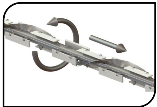
Figure IV.49 : Schéma qui explique le fonctionnement d'un échangeur à surface raclée
