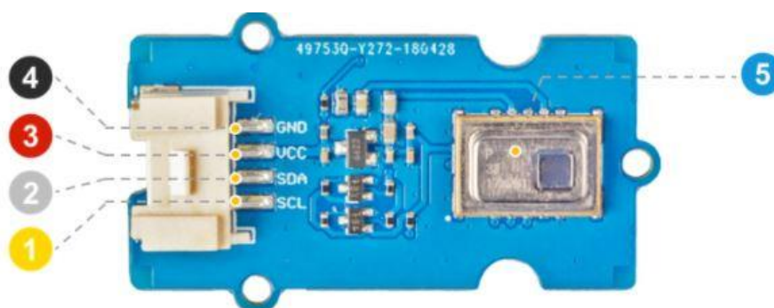
Figure 3.3 : Les pins du capteur.
