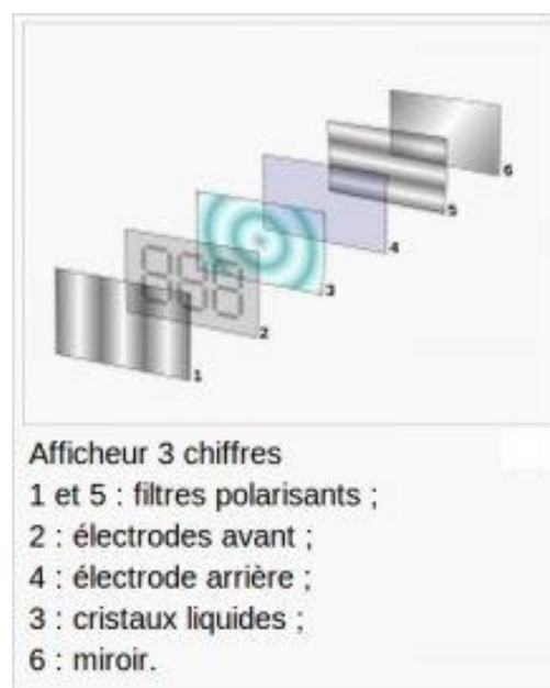
Figure 3.24 : Composition d'un écran LCD.
