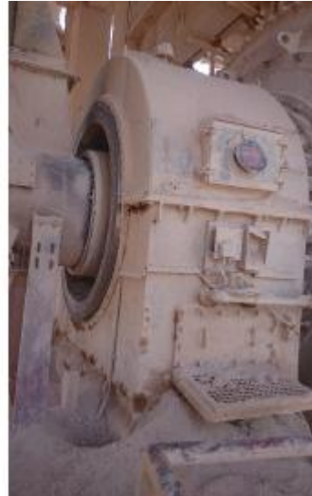
Figure 44 : palier de sortie et d'entrée
