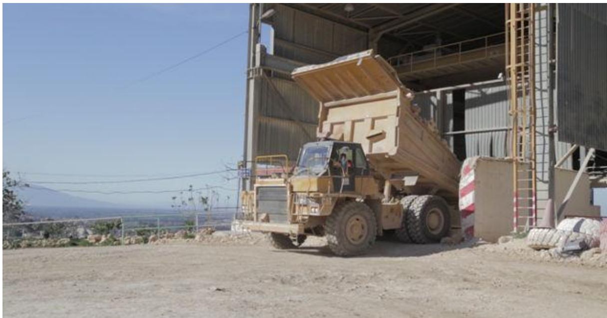
Figure 9 : Déchargement du calcaire dans le concasseur.
