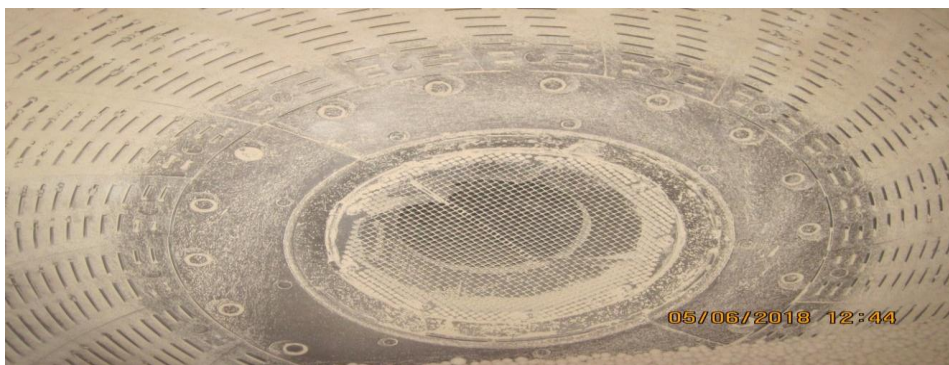
Figure 34 : Cloison des décharges :
