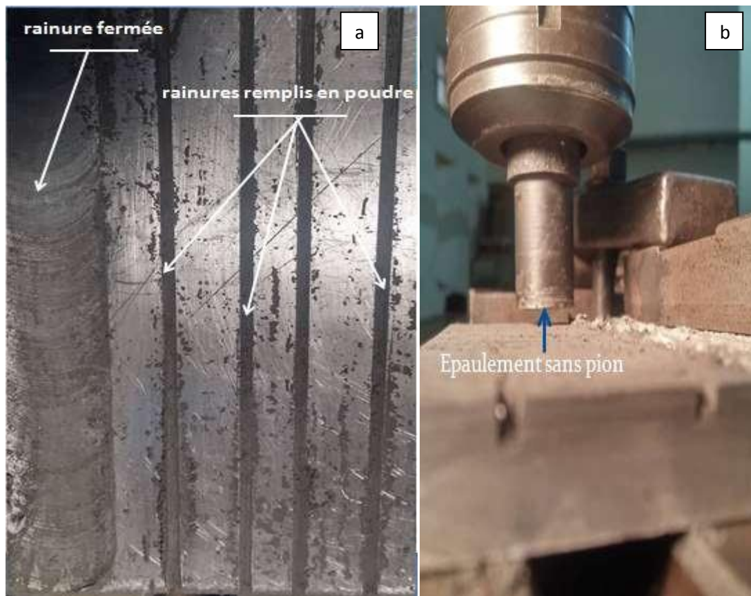
Figure III. 9 : a) remplissage de la poudre dans les rainures. b) outil sans pion.
