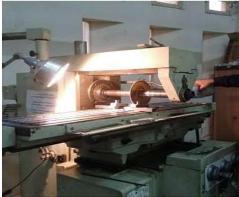
Figure III. 7 : le découpage de la tôle.
