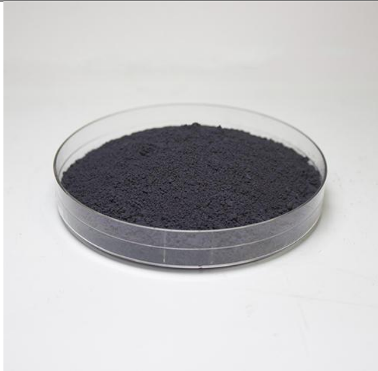
Figure III.4: borure d'aluminium de molybdène (MoAlB)
