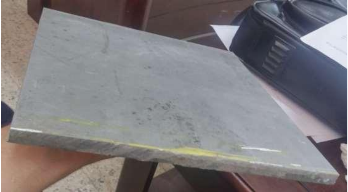
Figure III. 1 : tôle d'alliage d'aluminium 2024 T3.
