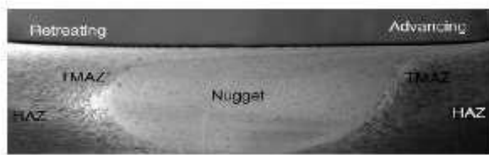
Figure II. 8 : Microstructure des différentes zones dans un joint pendant le FSP.[II-3]
