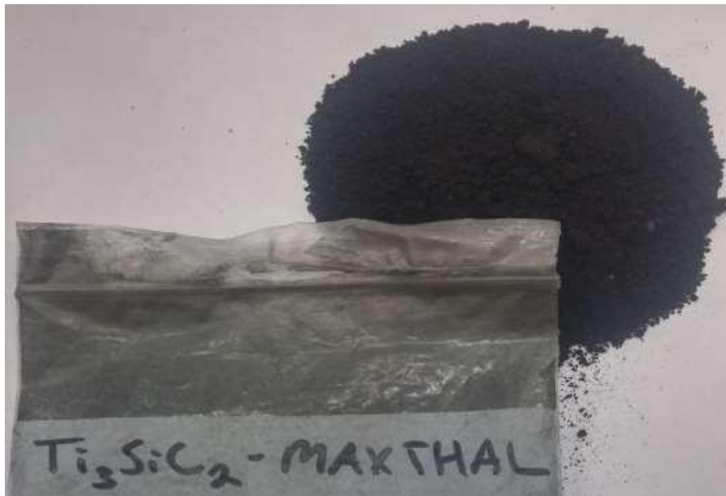
Figure III. 2 : la poudre de la phase MAX Ti_3SiC_2 .
