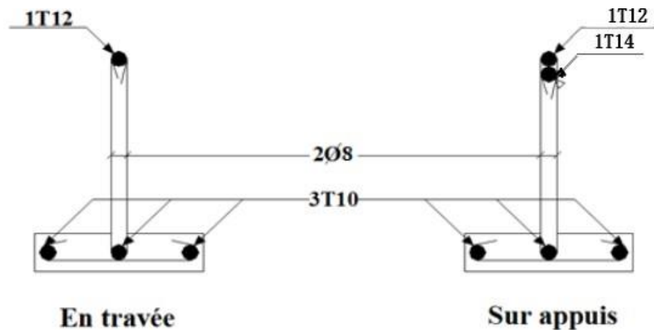
Figure III.17 : Ferrailage des poutrelles
