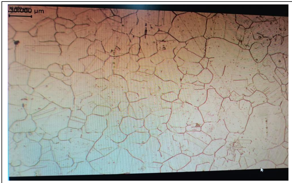
Figure III.4 : refroidissement à l'air
