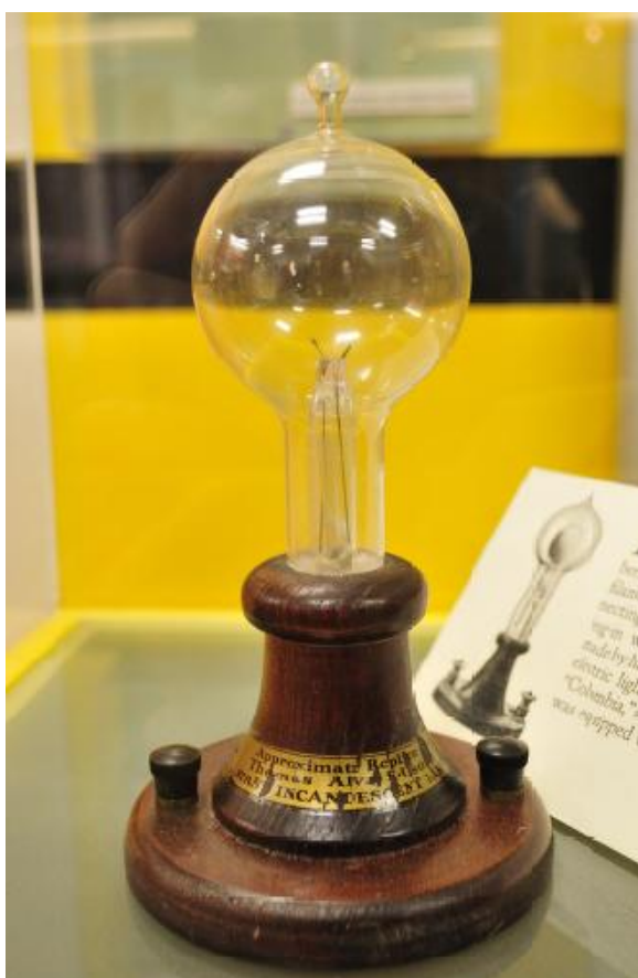
Figure II-1.23: Lampe à incandescence d'Edison.
