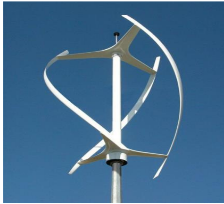
Figure I-12 : éolienne à axe vertical.
