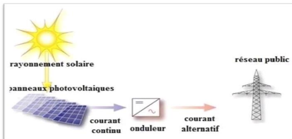
Figure I-10 : Le principe de fonctionnement de l'énergie photovoltaïque.
