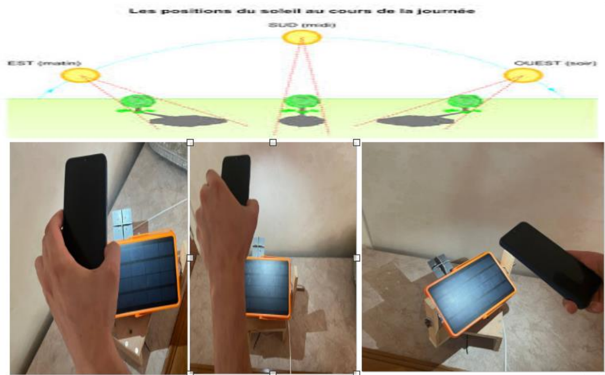
Figure (3- 8):suiveur solaire Suit la direction du soleil
