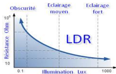
Figure (3- 2): la relation entre la résistance d'une photorésistance et l'éclairement
