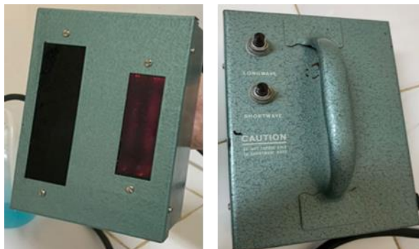
Figure 13 : La lampe UV portable "dual wave" (onde courte / 254 nm + onde longue / 365 nm) modèle UVGL 58 (378 × 81 × 64 mm).
