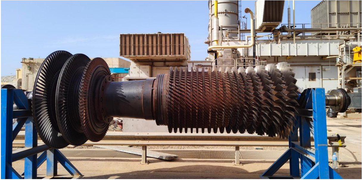
Figure 1.3: Section de compresseur avant montage
