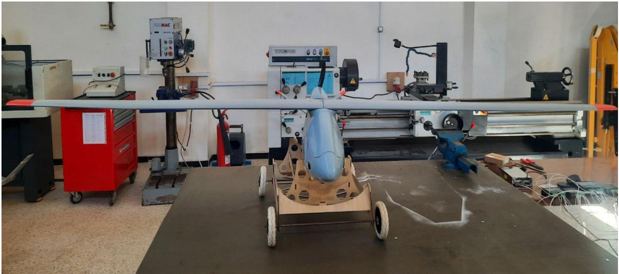
FIGURE 2. 5: Mini drone à voilure fixe mono poutre en V
