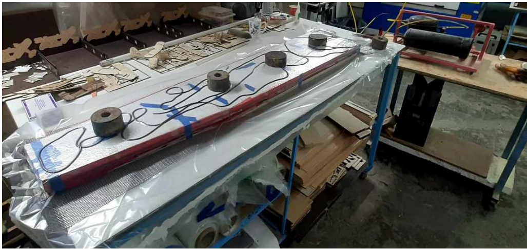
FIGURE 2. 48: Mise en place du système sous vide
