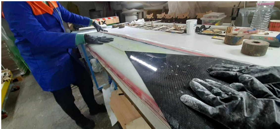
FIGURE 2. 47: Fin de l'opération de stratification
