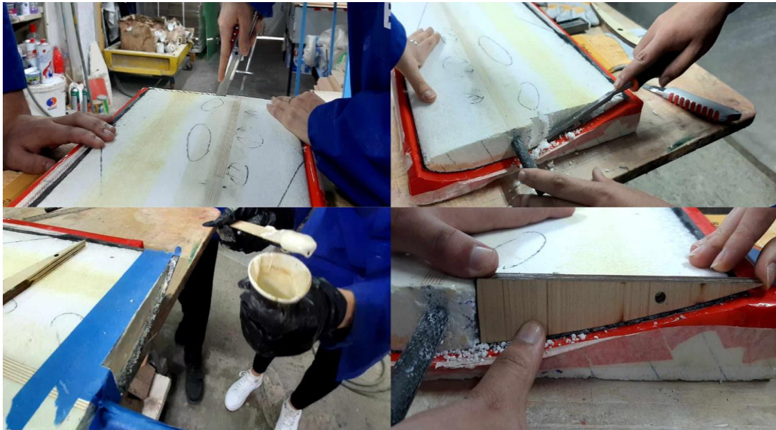
FIGURE 2. 40: Mise en place de la nervure finale dans la structure de la demi-aile
