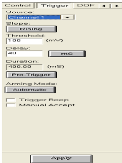
FIGURE 3. 10: Réglage de l'armement (marteau d'impact)
