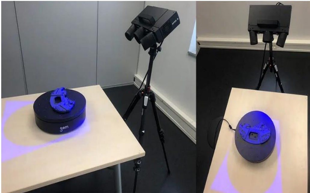
FIGURE 2. 2: Un scanner 3D de bureau avec table tournante automatique [3]
