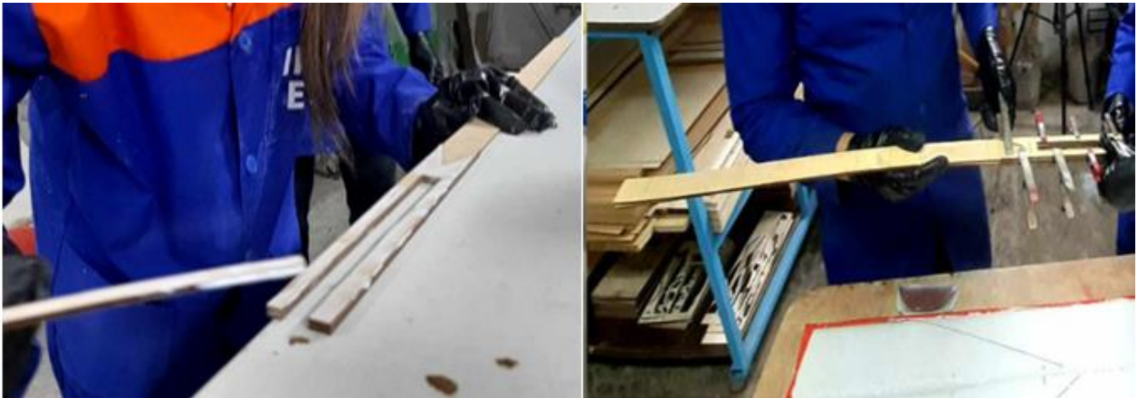
FIGURE 2. 37: Préparation du longeron
