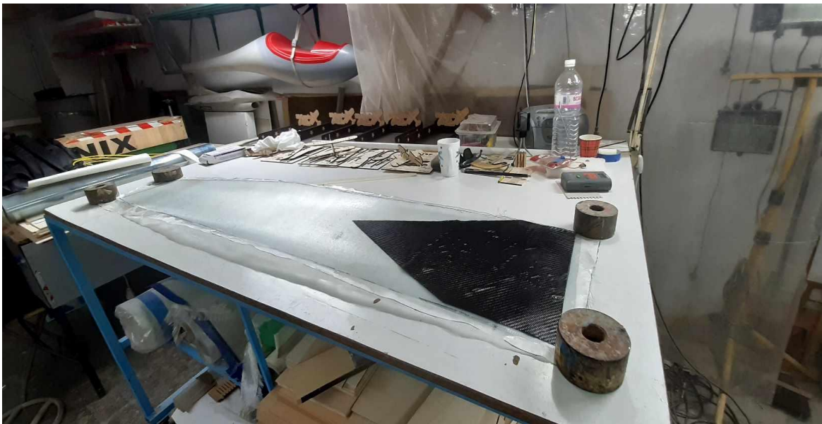
FIGURE 2. 45: État final des couches composites
