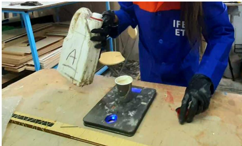
FIGURE 2. 42: Préparation de la résine
