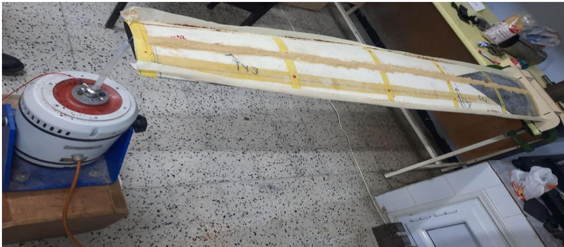
FIGURE 3. 45: Application de la poudre légère sur la demi aile
