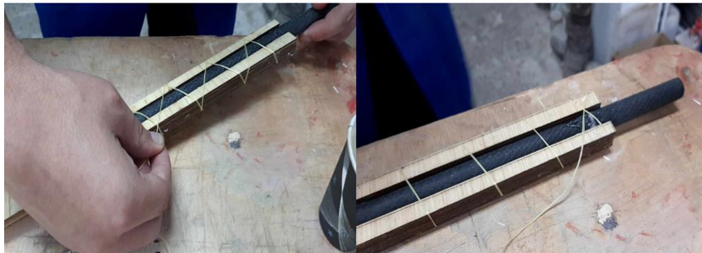
FIGURE 2. 38: Fixation du fourreau avec le longeron
