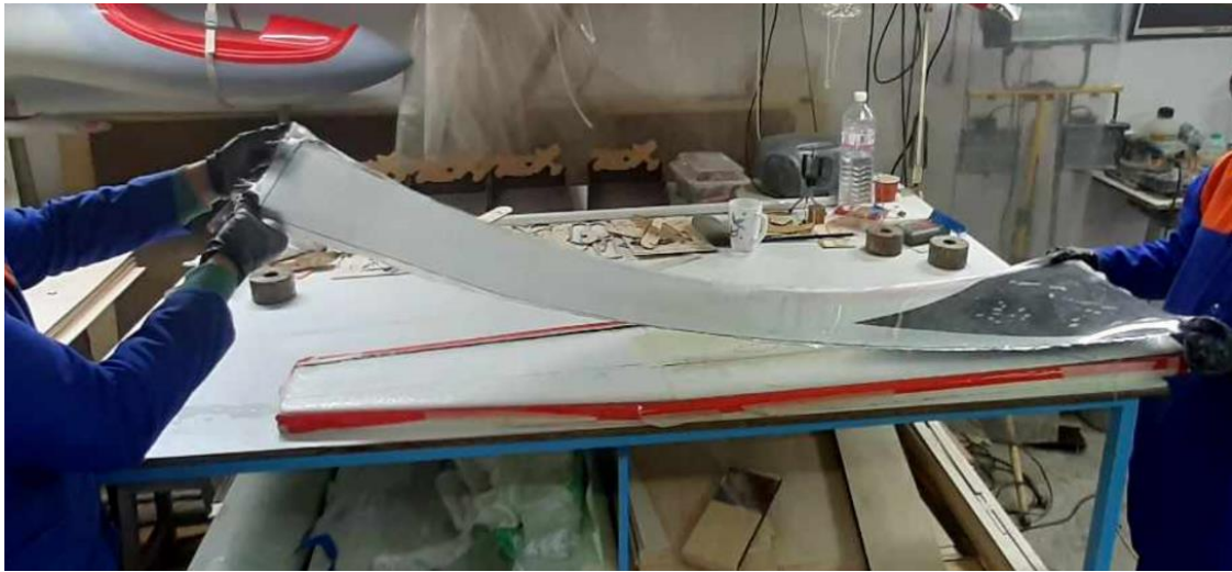
FIGURE 2. 46: Transfert de la stratification sur la mousse
