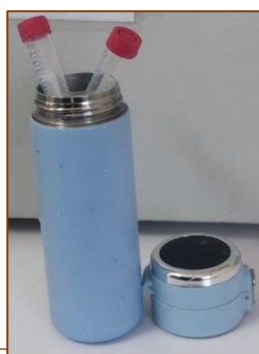
Figure 50 : Bouteille isothermique (qui servira à garder l'échantillon à une température ambiante de 37°C lors de son
