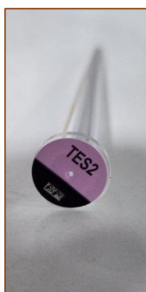
Figure 82 : Embout de test du système automatisé VIDAS (bioMérieux), utilisé pour la détection immunoenzymatique de la testostérone.
