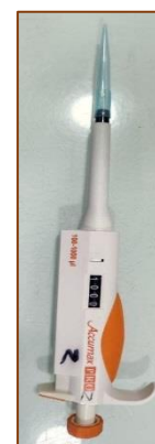
Figure 83 : Micropipettes réglables à embout jetable permettant la distribution du
