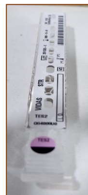
Figure 81 : Cartouche composée de puits contenant des billes magnétiques lyophilisées recouverte d'anticorps monoclonaux de souris anti-testostérone conjuguée avec la phosphatase alcaline.
