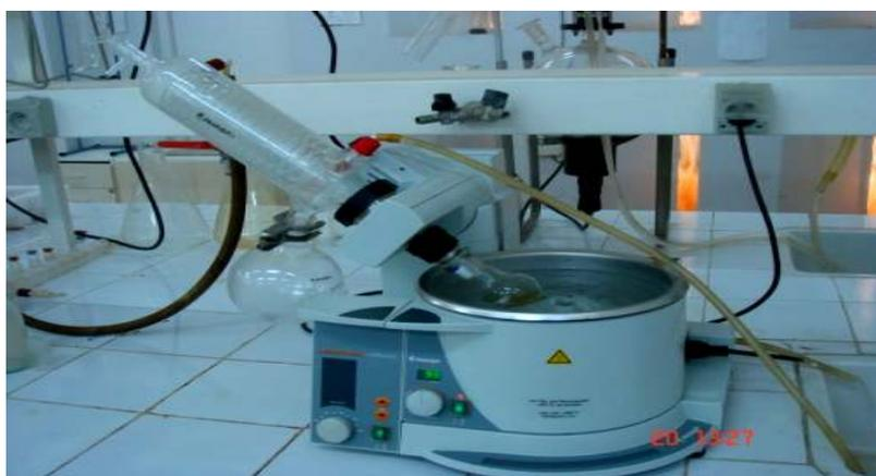
**Figure III-4** : Evaporateur rotatif**III-1-3-Calcul du rendement :**
