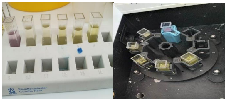
Figure 08 : La lecture par spectrophotomètre à 517 nm (Photos originales, 2025).
