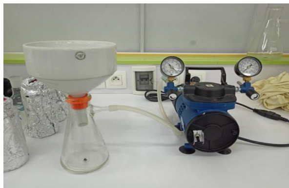
Figure 3.3 : Système de filtration sous-vide à l'aide d'une pompe. (Photo Originale)
