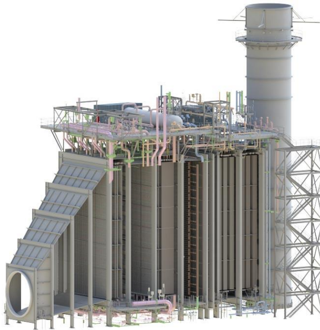
Figure 2.23 : Chaudière de récupération HRSG cap djinet
