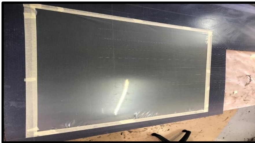
Figure II.6: Dépôt du mastic d'étanchéité sur la périphérie de la surface du moulage.
