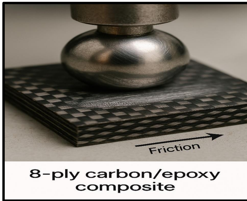
Figure III.4 : Schéma de l'essai tribologique sur le composite carbone/époxy à 8 plis
