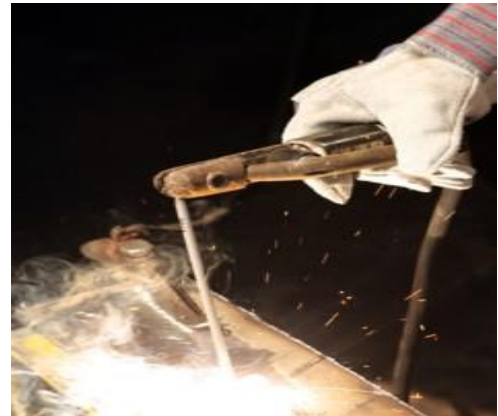
Figure 9 Image de l'arc électrique [9]
