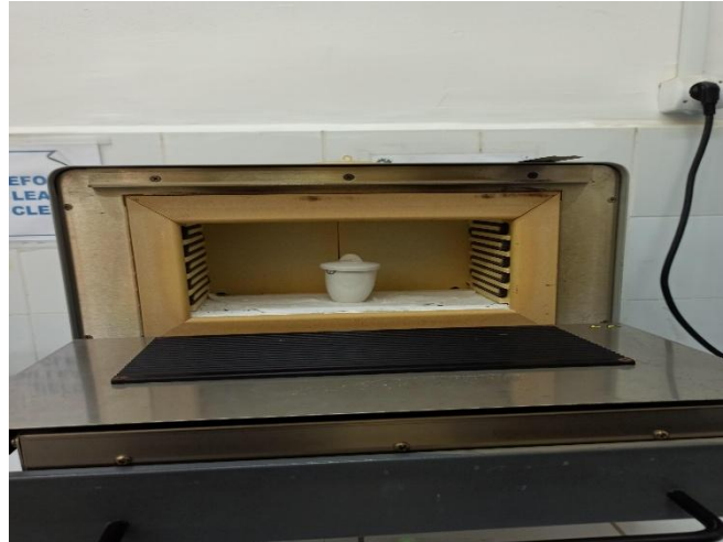
Figure III.8 : creuset au four électrique
