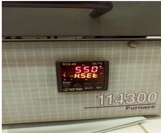
Figure III.9 : la température de frittage
