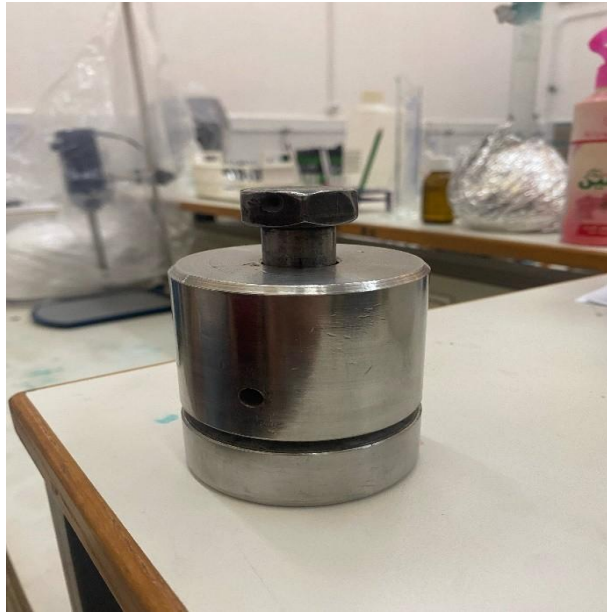
Figure III.3 : Dispositif de compactage.
