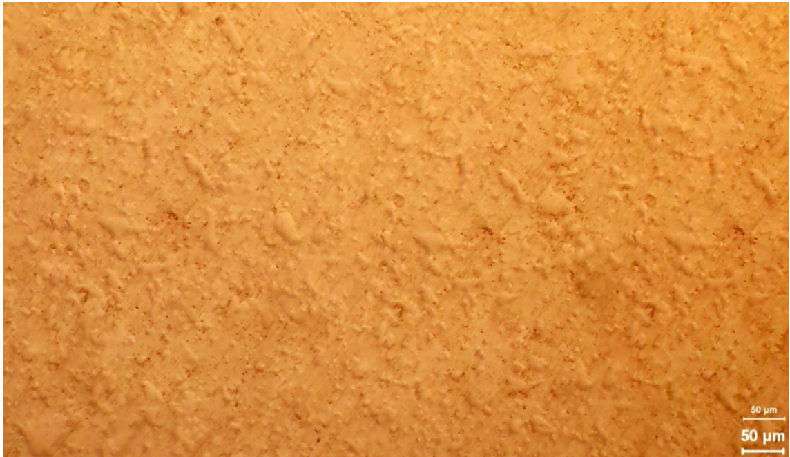
Figure 3.10: Microstructure d'un échantillon traité de 1020 °C, trempé à l'huile, revenu 500C
