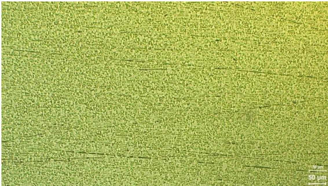
Figure 3.12: Microstructure d'un échantillon trempé de 1020 °C + 2 revenus à 150 °C.
