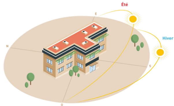
Figure 13:L'effet de l'orientation des ouvrants pour capter la lumière, Source :(DECU 2024)
