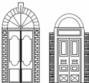
Figure 103 : porte décorée en maçonnerie
