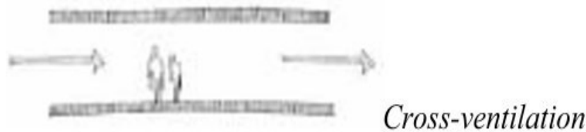
Figure 8 : La ventilation transversale, (Kleiven, 2003).
