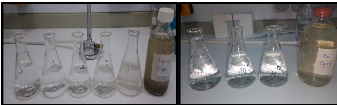
Figure 24 : Principe de la dilution d'eau usée brutes et traitées (Originale, 2025).
