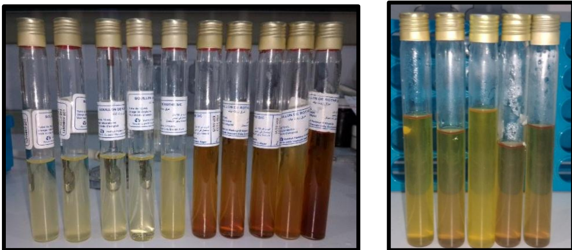
Figure 38 : Lecture des résultats des Streptocoques fécaux d'eau brute (Originale, 2025).
