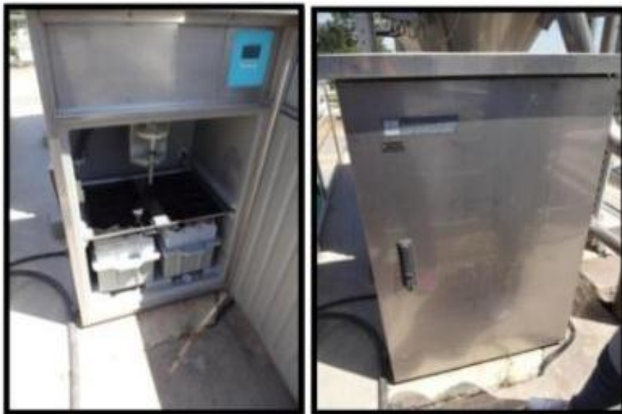
Figure 21: Échantillonneur automatique (Originale, 2025).
