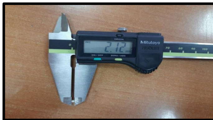
Figure II.15: Instrument de mesure : pied à coulisse digital.
