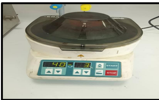
Figure II. 13 : Le dispositif du test de stabilité d'émulsion.
