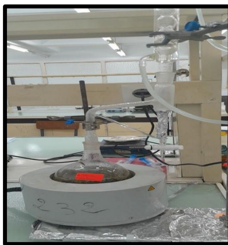
Figure II.4 : Montage de l'hydrodistillation (Clévenger).
