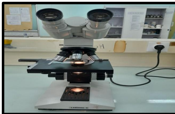
Figure II. 12 : Microscope optique utilisé pour l'étude morphologique de l'émulsion.
