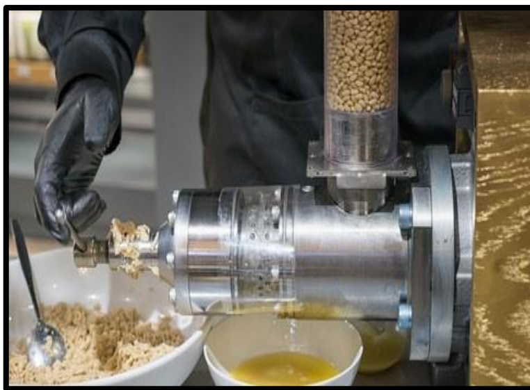
Figure I.10 : Extraction mécanique de l'huile végétale par pression à froid [93].
