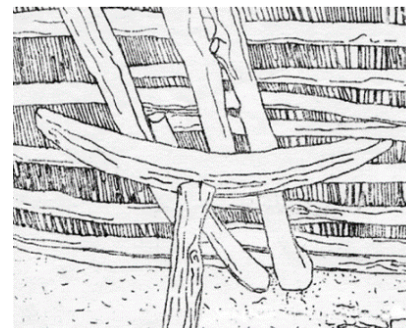
Figure 32 : support de planche d'une chambre à Roufi, dans les Aurès (J. Bachminski et D. Grandet)
