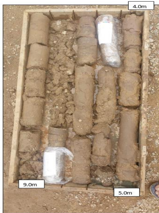
Sondage carotté profondeur de 4,00 m à 9,00 m
