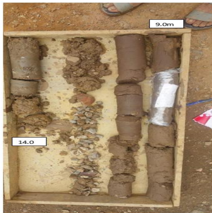
Sondage carotté profondeur de 9,00 m à 14,00 m
