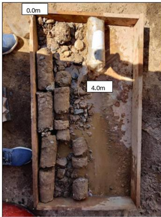
Sondage carotté profondeur de 0,00 m à 4,00 m
