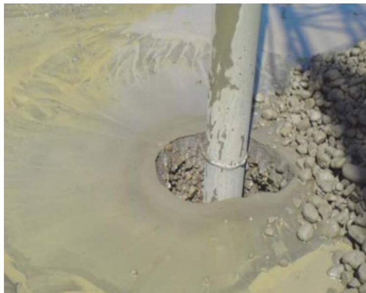
Figure 1.13 : Phénomène de liquéfaction local (Site : barrage Kissir- Jijel).[6]
