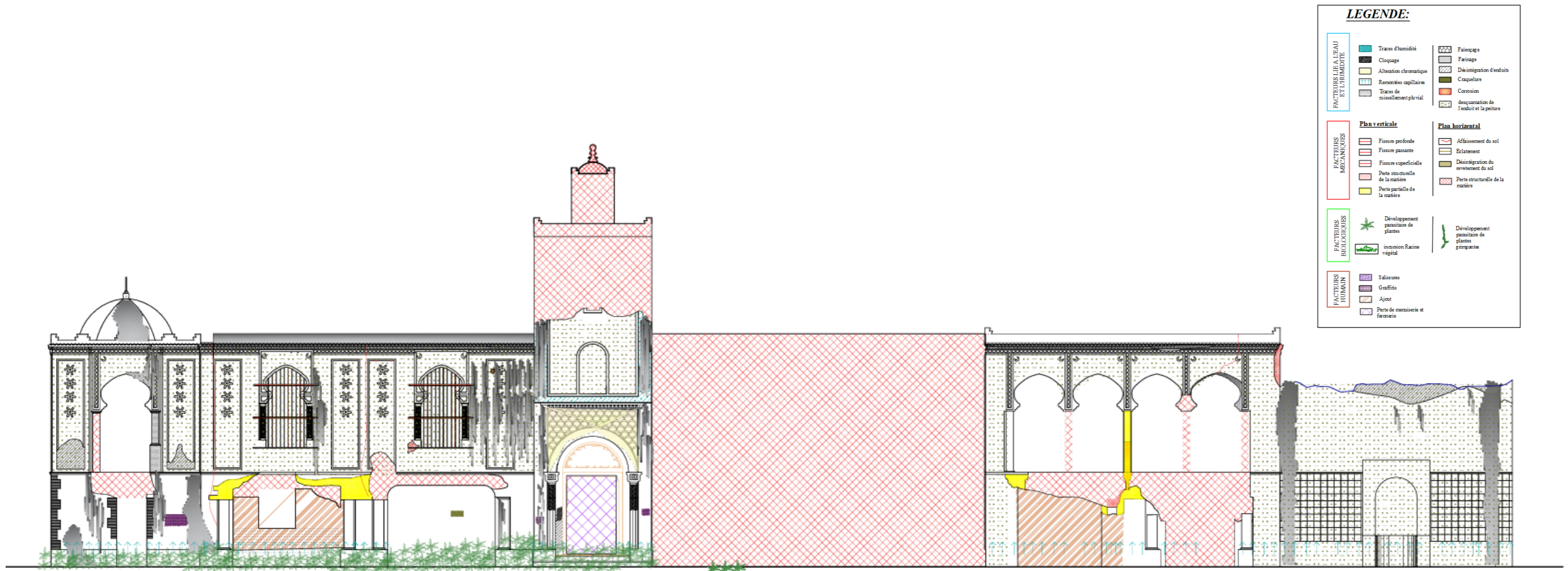
Figure 68: identification des pathologies sur la façade Ouest.
