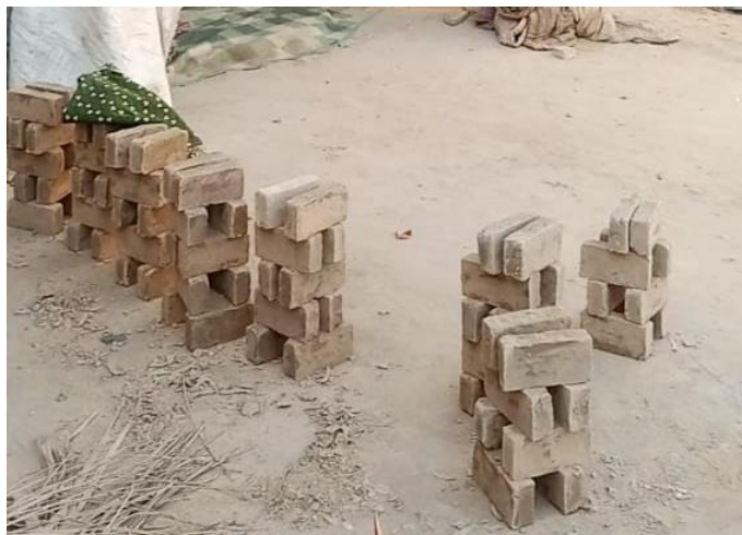
Figure 119: des briques locales de Touggourt avec leurs dimensions de : 20 cm. 10cm.5cm, source auteur
