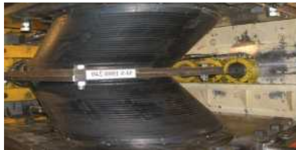
Figure 63: Tests d'isolateur sismique de 1000 mm source : https://www.buildingcue.it
