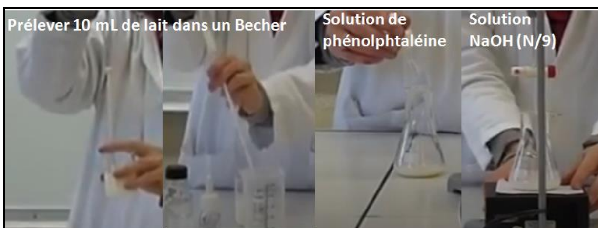
Figure 28 : Etapes de la mesure de l'acidité Dornic.
