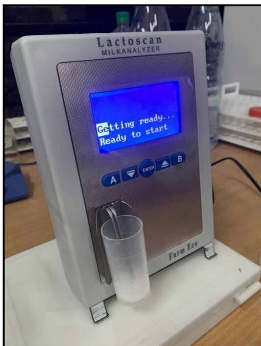
Figure 18 : Analyseur de lait Lactoscan.
