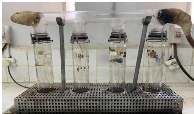
Figure 19 : Étape de minéralisation des échantillons
