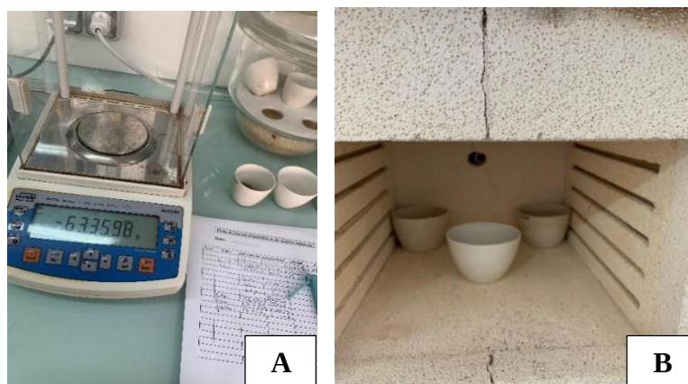
Figure 16: Protocole du taux de cendres A : pesée du matériel végétal B : four à moufle.
