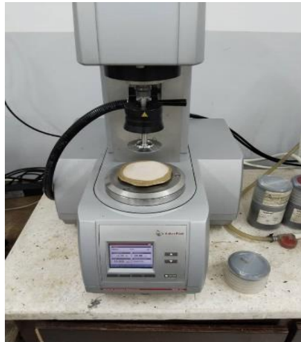
Figure A3.1 :rhéomètre à vitesse de cisaillement imposée (Modular Compact Rheometer, MCR 302)
