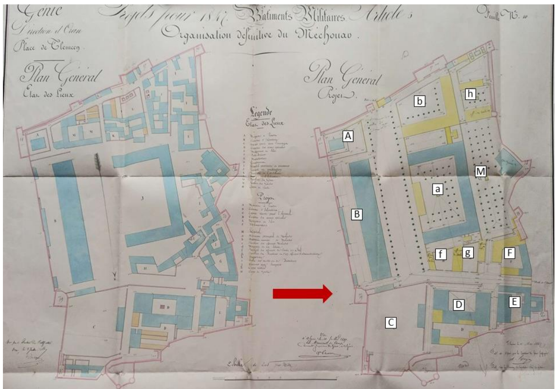
Figure 19: plan de transformation du palais Zianide d'El Mechouar en caserne militaire 1847 (source : Archives SHD, Vincennes : Fonds de l'armée de Terre - Série H- sous série 1H, carton : 1VH 1810)
