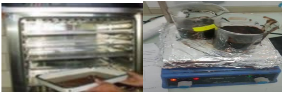
Figure 9 : Séchage des boues et agitation des boues
