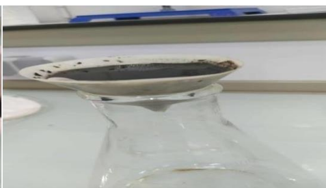
Figure 8 : Filtration des boues
