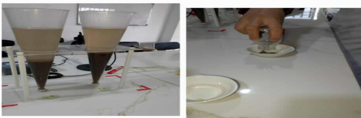
Figure N°23: Processus de préparation de MES
