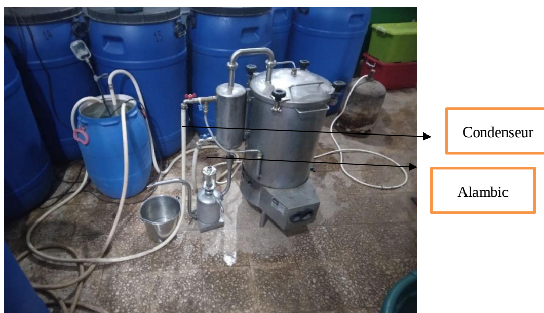
Figure 10 : Dispositif de distillation à la vapeur utilisé pour l'extraction de l'huile essentielle (Original, 2025)
