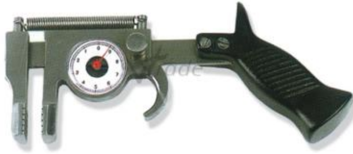
Figure 06 : cutimètre à ressort homologué (vetagro-sup, 2025)
