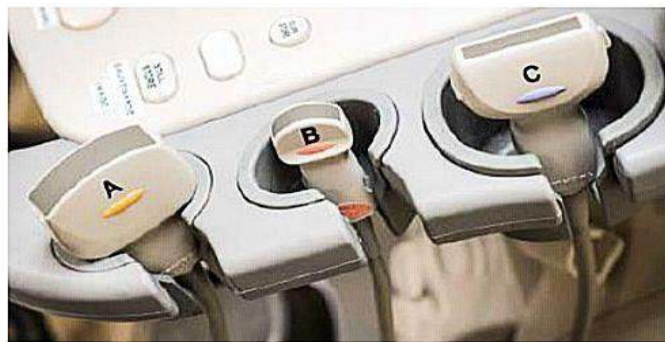
Transducteurs utilisés en pratique A : Transducteur convexe ; B : Transducteur micro-convexe ; C : Transducteur linéaire Source : « Atlas of small animal ultrasonography » (Penninck, d'Anjou 2015)
