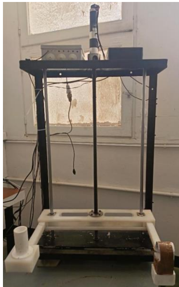
Figure II.4 : L'élévateur automatique de la source et détecteur
