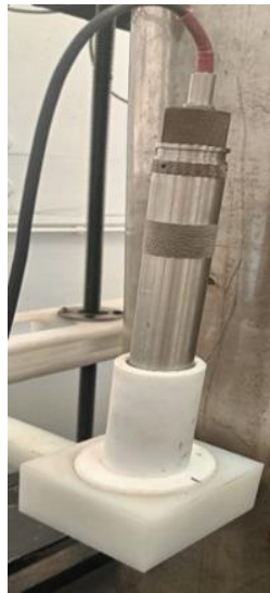
Figure II.2: Détecteur NaI (Tl) sur le support
