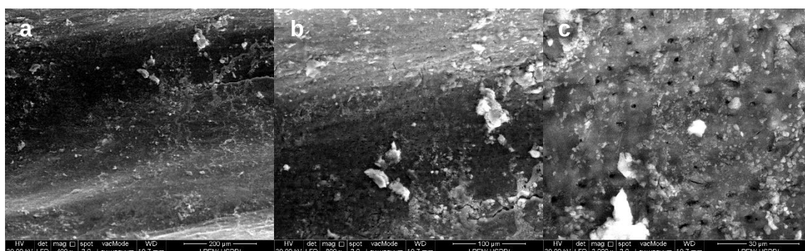
Fig2 : observation MEB des débris et de la Smear layer tiers coronaire : (a) Visualisation à faible grossissement ( \times 400 ), (b) À grossissement moyen ( \times 800 ), (c) Analyse à fort grossissement ( \times 3000 ).
