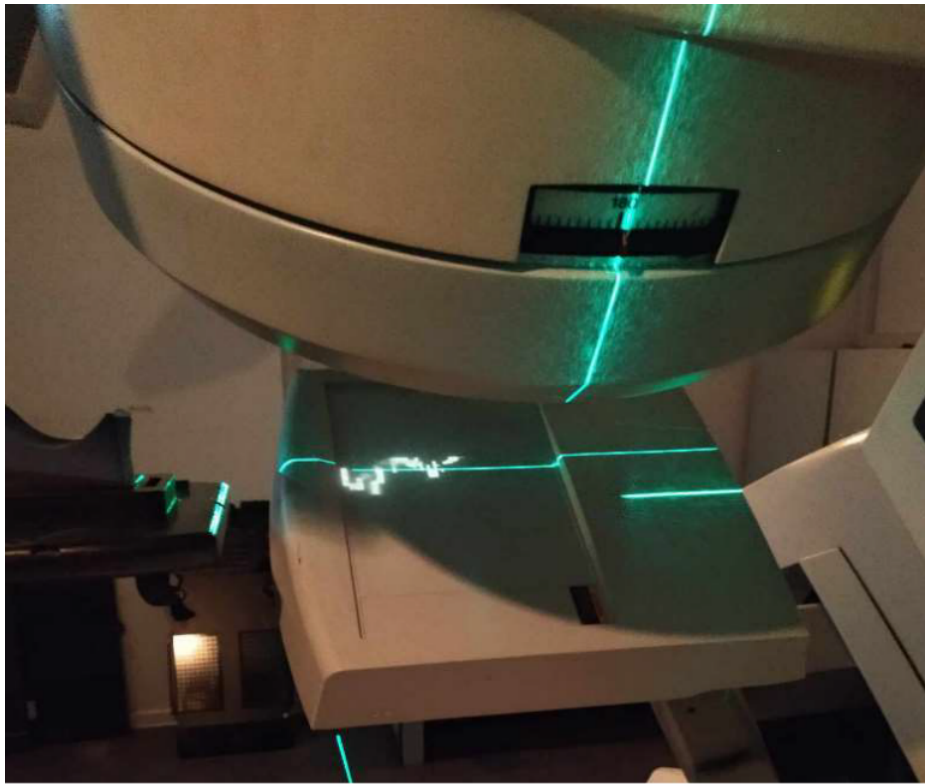
FIGURE 3.32 – Portail dosimétrique intégré
