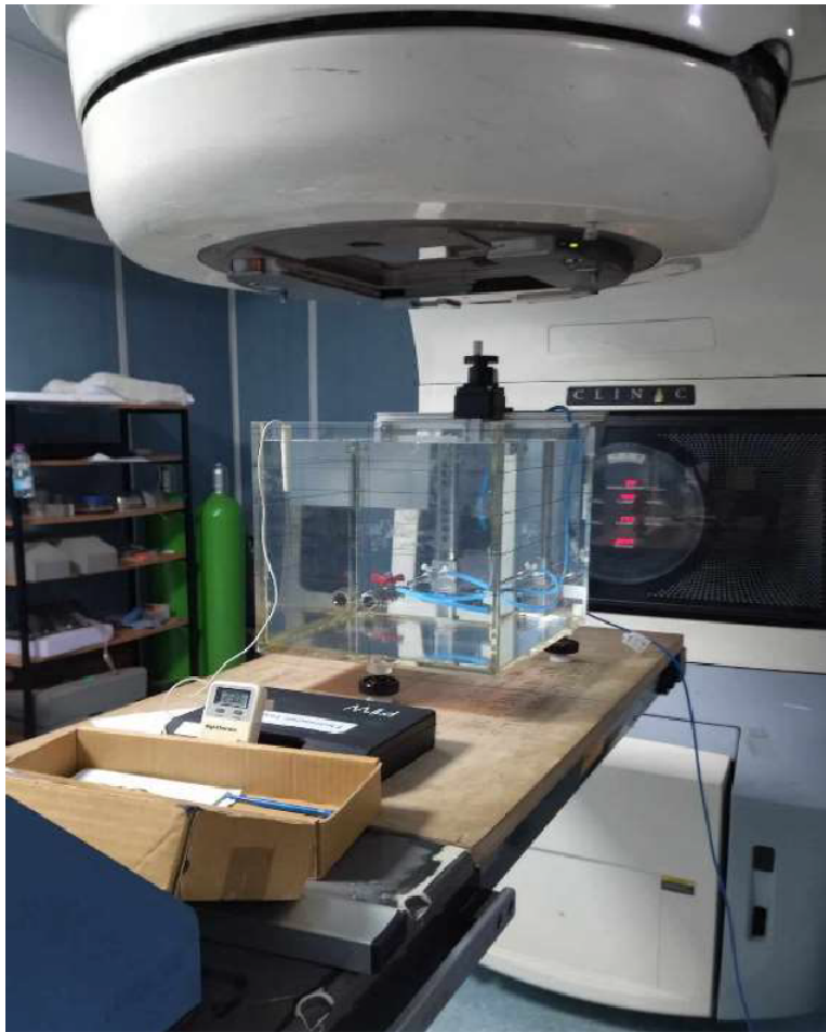
FIGURE 3.11 – La cuve à eau MP1.
