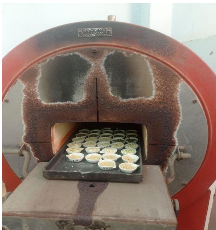
Figure N°25 : les échantillons dans le four à moufle (originale 2025)
