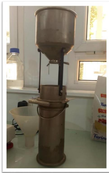
Figure 19. Le testeur du poids spécifique
