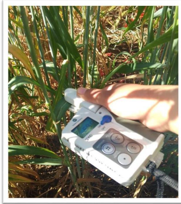
Figure 15. Mesure de la chlorophylle foliaire à l'aide du SPAD
