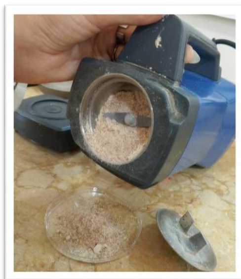
Figure 18. Le broyage des échantillons
