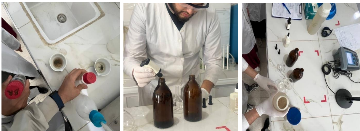
Figure 47 : mesure de DBO5 au niveau de laboratoire (STEP de Benimered) (Originale, 2025).
