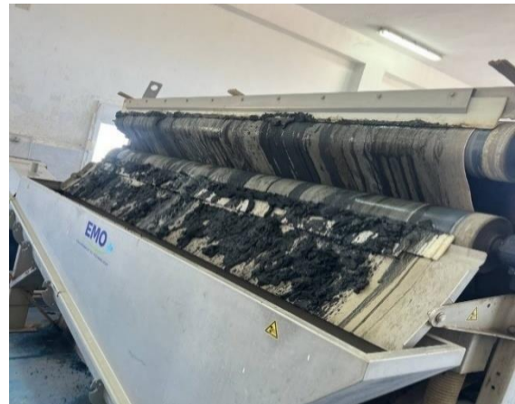
Figure 22 : Filtre à bande lors de la déshydratation de la STEP de Boufarik (Originale, 2025).
